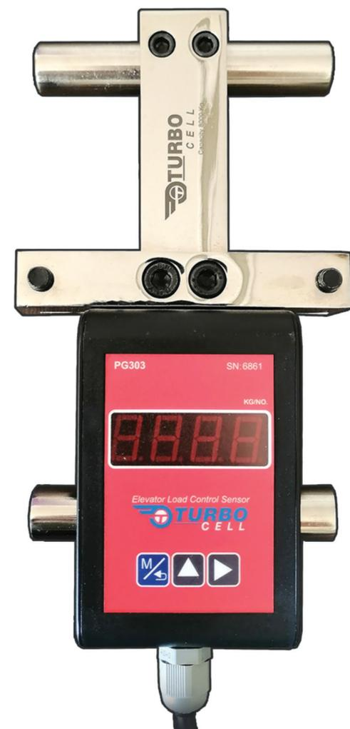
سنسورهای اورلود سیم بکسلی توربوسل در مدل های مختلف برای نصب بر روی کابین طراحی و تولید می شود. سنسور سیم بکسلی با اندازه گیری میزان کشش سیم بکسل، وزن کابین و سرنشینان را محاسبه می کند.
